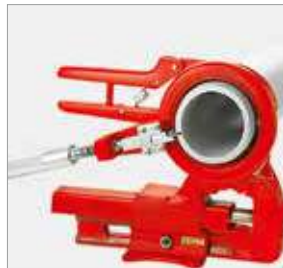
Fijación en tornillo de banco
