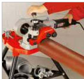
Uso con la herramienta de ranurado ROGROOVER
