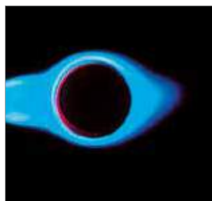
Llama de alta temperatura gracias al efecto ciclón
