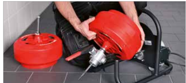
Tambor intercambiable para distintos rangos de trabajo
