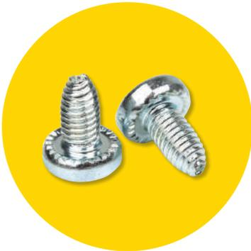
Los tornillos rosca TRILOBULAR® FASTITE® 2000™ han sido especialmente desarrollados para el ensamblaje de chapas finas de acero y aluminio (grosor hasta 1/3 del diámetro nominal del tornillo), garantizando la compresión de la unión sin riesgo de pasado de rosca.
