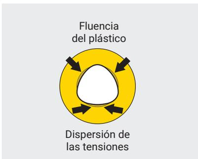
**Fig.10.** Fluencia del plástico hacia el interior. El espacio entre lóbulos absorbe y dispersa las tensiones creadas durante el roscado.
