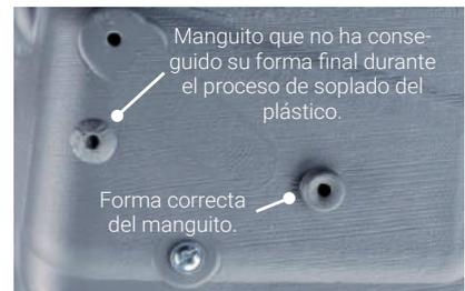
**Fig.17.** Problemas de fluidez del plástico en los manguitos para piezas de plástico soplado. La utilización de tornillo TWINPLAST evita la necesidad de diseñar manguitos y asegura la fijación en piezas de plástico soplado.
