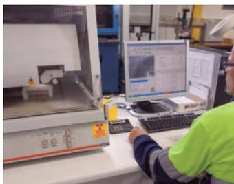
**Fig.48.** Medición del espesor de capa por rayos-X.
