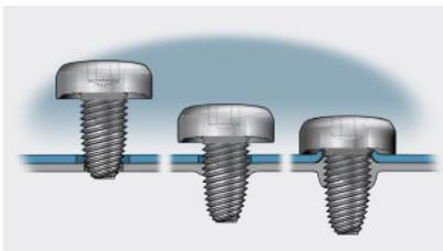
**Fig.42.** La punta especial provoca una extrusión en la chapa durante el proceso de roscado, aumentando la longitud de ensamblaje y por lo tanto, la resistencia al arranque.
