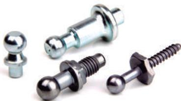
Los tornillos de bola son piezas formadas por una cabeza con forma de bola y un vástago que puede tener diferentes diseños de rosca en función del material base. La cabeza está diseñada para proporcionar un rápido montaje y desmontaje. Asimismo, las piezas ensambladas mediante este elemento de unión permanecen unidas de forma móvil.
