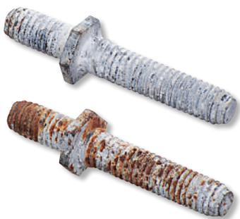
**Fig.49.** Aparición de corrosión blanca y corrosión roja en los tornillos.
