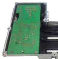
**Fig.32.** Detalle parcial de ensamblaje de placa PCB sobre aluminio de un Cargador a bordo (OBC) en vehículos eléctricos.
