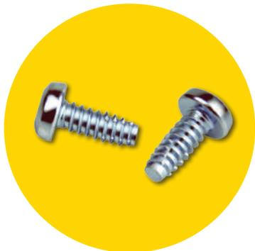
Los tornillos IBI-ZAS se recomiendan especialmente para el ensamblaje sobre plásticos termoduros. Debido a la naturaleza de este tipo de plásticos, no se aconseja la utilización de tornillos estándar para plásticos, ya que la tensión radial a la que se somete la pieza base durante la formación de la rosca puede producir el agrietamiento de los manguitos.
