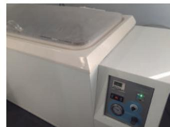
**Fig.50.** Los ensayos en la cámara de niebla salina se realizan de acuerdo a lo establecido en el plan de control.
