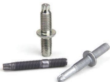
El espárrago doble rosca combina dos roscas en su longitud. Se utiliza para aquellas aplicaciones en las que es preciso facilitar el ensamblaje de dos piezas. Una de las roscas queda montada en la primera pieza, permitiendo el ensamblaje de una segunda pieza con una tuerca. La multifuncionalidad de estas piezas nos permite ofrecer numerosas posibilidades de reducción de costes.
