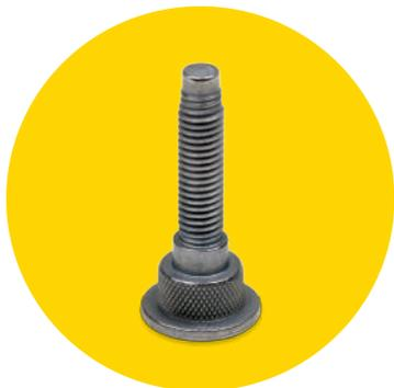
La punta MATHread® utiliza un diseño de rosca patentada que se aplica a los tornillos con rosca métrica para evitar el cruzado de roscas y/o bloqueo durante su instalación.
