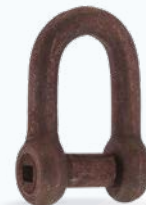
Grillete recto pesca con cabeza cuadrada Disponible desde 16/20 mm hasta 22/25 mm W.L.L. hasta 6.500 kg
